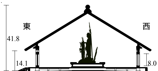
図7 浄土寺浄土堂断面図 単位：寸
