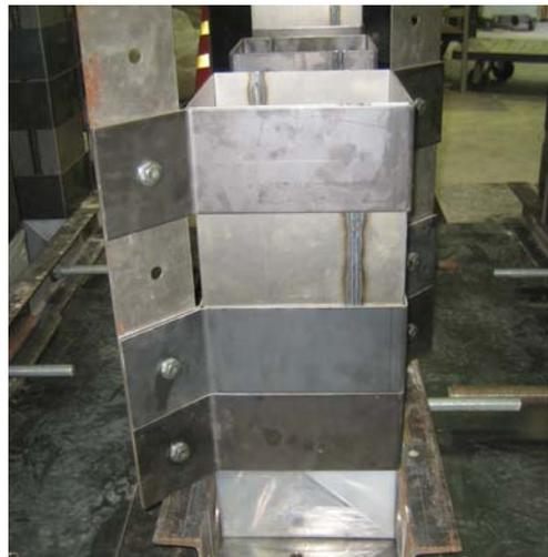
写真-2 支保工による鋼管形状管理
